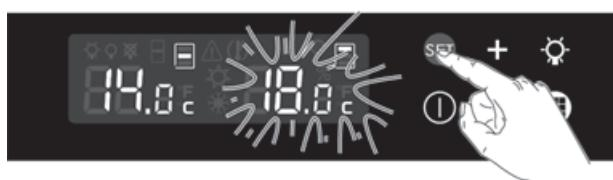
3 Appuyez sur le bouton **SET** pour valider. L'afficheur de température du compartiment de chambrage clignote.
