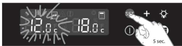
Pulse 5 s la tecla **I** para ponerlo en funcionamiento.
