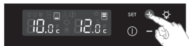
2 Pulse las teclas **+** o **-** para regular la temperatura de consigna deseada en el compartimento de enfriamiento.
