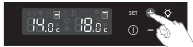
2 Appuyez sur les touches **+** ou **-** pour régler la température de consigne désirée dans le compartiment de vieillissement.
