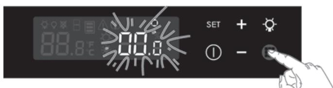
Lors de la mise en service ou du remplacement du filtre, régler le compteur sur 365.
