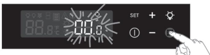
Al momento della messa in funzione o della sostituzione del filtro, impostare il contatore su 365.
