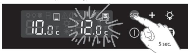
3 Druk op de knop **SET** om te bevestigen. De temperatuurweergave van het bewaarvak knippert.
