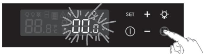
Al poner en marcha el aparato o al sustituir el filtro, ajuste el contador a 365.
